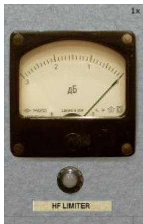
図 26. 高域リミッタ右上に位置する “1x/4x”スイッチ
