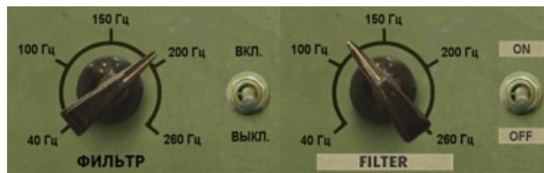
Рисунок 8. Выключатель и регулятор фильтра верхних частот управляющего сигнала
