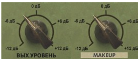
Рисунок 12. Регулятор выходного уровня сигнала
