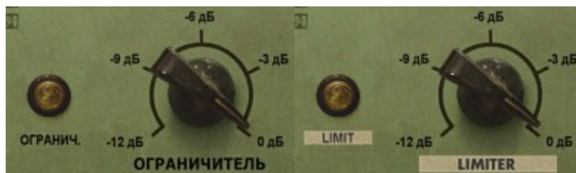
Рисунок 13. Световой индикатор и регулятор ограничителя
