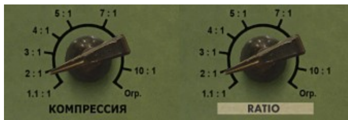
Рисунок 5. Регулятор степени сжатия динамического диапазона
