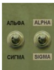
Рисунок 9. Переключатель режима атаки
